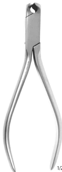
116 91 0001 14,5 cm pro měkký drát do průměru 1,5 mm for soft wires up to diameter 1,5 mm für weichen Draht bis Durchmesser 1,5 mm pro tvrdý drát do průměru 1,0 mm for hard wires up to diameter 1,0 mm für harten Draht bis Durchmesser 1,0 mm
