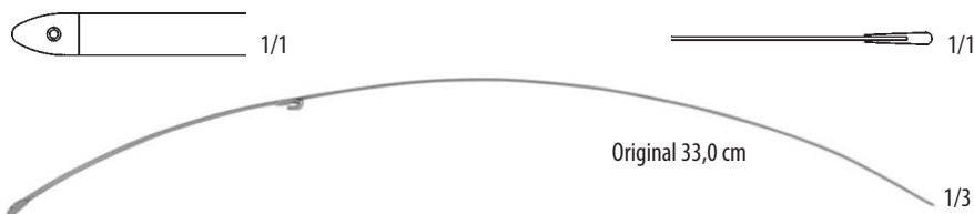
ZAVADĚČ DRÁTĚNÝCH PILEK CONDUCTOR FOR WIRE SAWS 133 17 0061 33,0 cm 133 17 0070 25,0 cm
